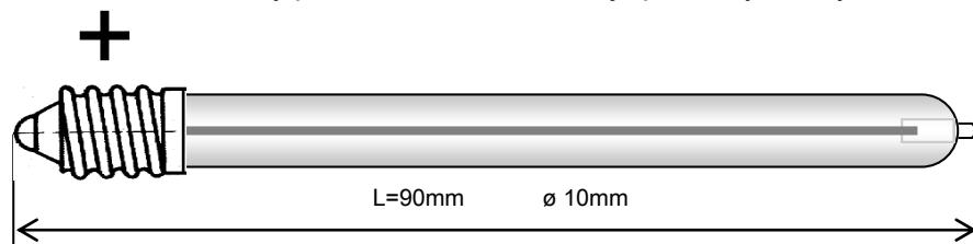
Skleněné těleso sondy je na jednom konci opatřeno normalizovanou paticí E10 pro snadnou montáž a případnou výměnu. Těleso závitu sondy nesmí být pájeno.
