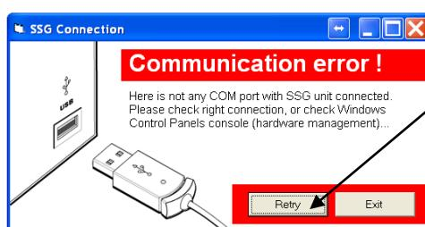
Toto hlášení o chybě se objeví, pokud zařízení (generátor) není připojeno. Zapojte generátor do portu USB a případně zkонтrolujte, zda-li jsou správně nainstalovány ovladače (postup naleznete na CD v souboru INSTALACE.TXT)
