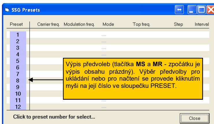
Generátor SSG si po nastavené době za určitý čas uloží aktuálně nastavené parametry do vnitřní paměti a ty si potom zpětně načte při dalším zapnutí (více v popisu ovládání SSG20)
