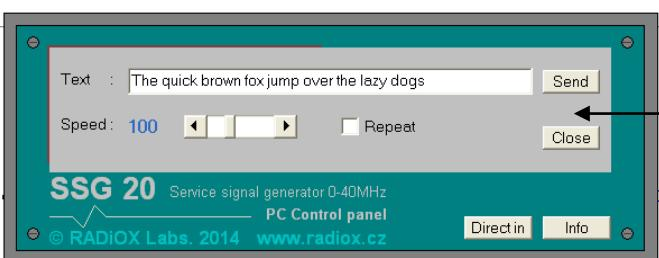
Generátor SSG20 má vestavěn překladač Morseovy abecedy. Tlačítkem CW se zobrazí textový řádek, do nějž můžeme napsat větu, kterou si přejeme odeslat (stiskem klávesy ENTER, nebo tlačítkem SEND). Je možno nastavit rychlosť vysílání pomocí posuvníku. Nastaviteľná rychlosť (Speed) označuje počet znakov za minutu. Tento režim se ukončí tlačítkem CLOSE. V průběhu vysílání textu je možné operaci přerušiť stiskem tlačítka MODE na generátoru - přímo z programu vysílání přerušit nelze.
