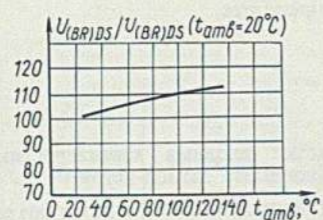
Зависимость относительной величины пробивного напряжения сток-исток от температуры окружающей среды Relative value of drain-to-source breakdown voltage versus ambient temperature
